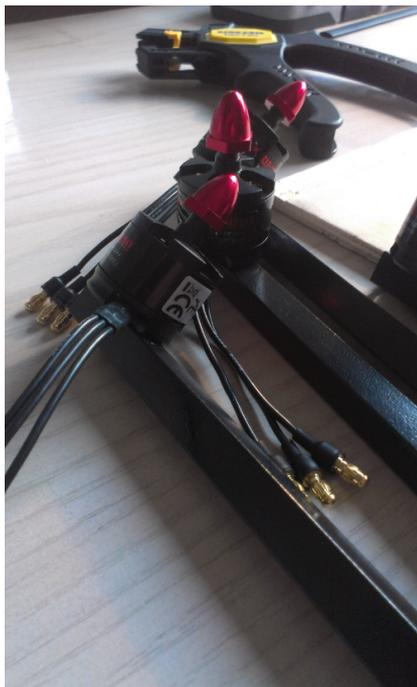
Abb. 2.2: Bürstenlose Motoren
